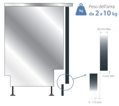
Le cerniere sliding sono state sviluppate per differenti pesi e spessori del pannello. Il peso dell'anta può variare da 2 a 10 kg, e lo spessore da 16 a 40 mm.
